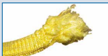
ROTURA POR TENSIÓN
