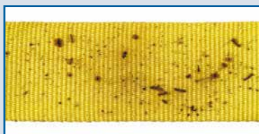
SALPICADURAS DE SOLDADURA
