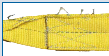
PUNTADAS ROTAS O DETERIORADAS
