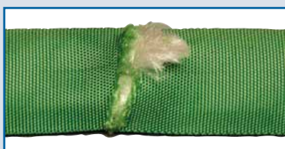
HILATURA CORTADA O DAÑADA
