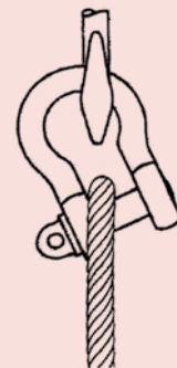
Tiro incorrecto. Puede deformar la boca
