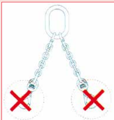
Ganchos mal orientados. Siempre deben mirar al exterior.
