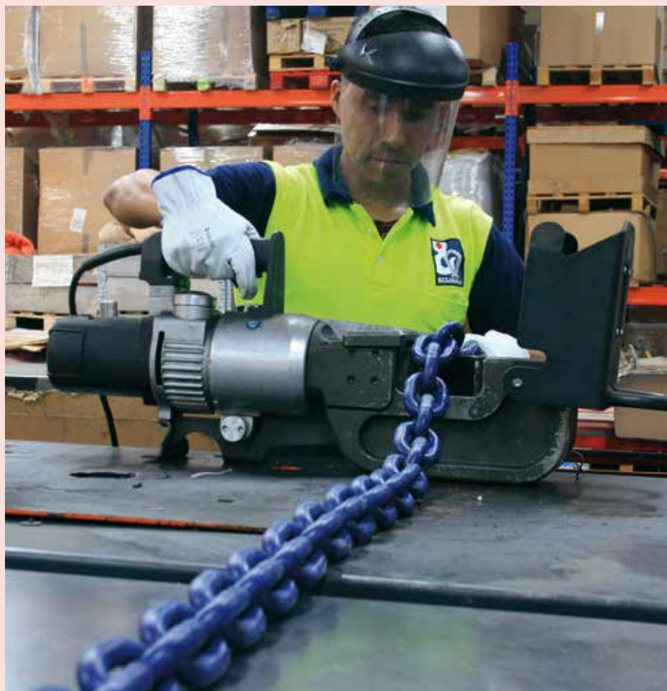
Equipo móvil para cortar cadena de forma rápida y segura.
