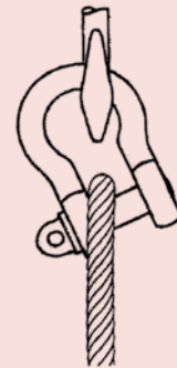
Tiro incorrecto. Puede deformar la boca
